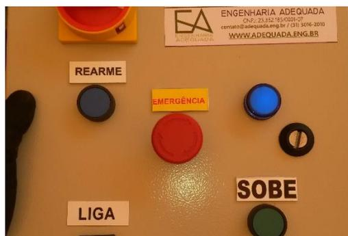
5. Pressionar o Botão Liga (verde) para acionar o funcionamento do motor do tambor do equipamento:
