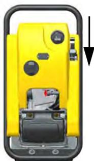
1. Lentamente coloque a alavanca de aceleração em posição OFF. A torneira de combustível fecha automaticamente.
