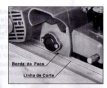
Ajuste a guia reta tomando como referência a lateral da peça de trabalho, após acerto aperte o parafuso na parte frontal da ferramenta.
