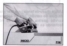
da ferramenta no início da plainagem. O trabalho se torna mais fácil se a peça de trabalho é fixada firmemente. A velocidade e a profundidade de corte determinam o tipo de acabamento. A força motriz da ferramenta corta a uma velocidade que não ocorrerá obstáculos devido ao cavaco. Para um corte grosseiro poderá se trabalhar com uma profundidade de corte elevada, porém para um bom acabamento da superfície deve-se reduzir a profundidade de corte e avançar a ferramenta mais lentamente.
