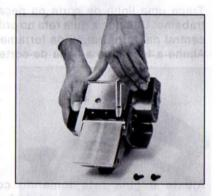
Para instalar as facas, primeiro limpe os cavacos e os materiais estranhos aderidos no tambor ou nas facas. Use facas de mesmo tamanho e peso, para não ocorrer vibrações/oscilações.
